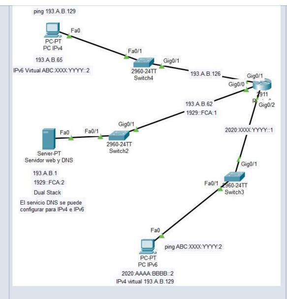
Para verificar la conexión entre los equipos realiza un ping entre todos los equipos desde el "Comand Prompt" ubicado en la pestaña Desktop. El equipo que tiene sólo IPv4 puede hacer ping usando la dirección IPv4 virtual asignada al equipo con IPv6 y viceversa.
